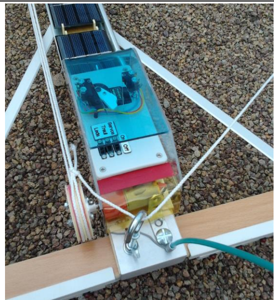
Commande du treuil de la voile par servomoteur
