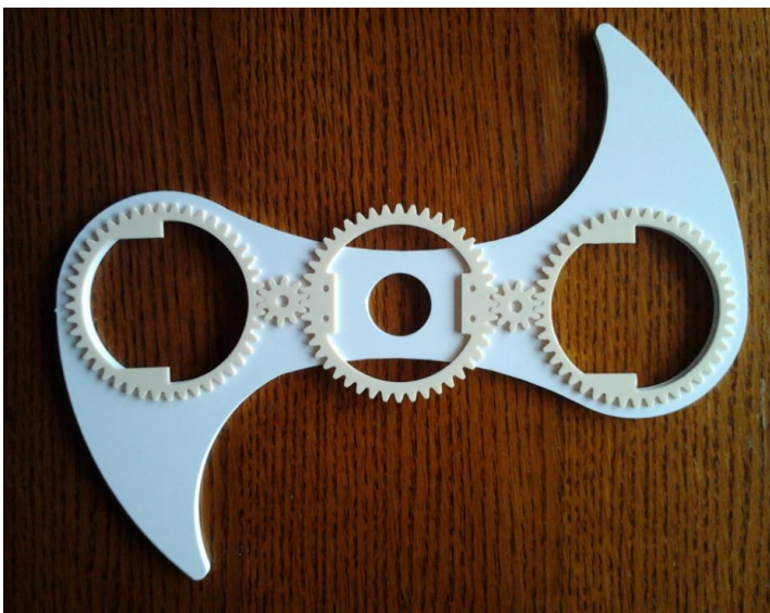
Vue du mécanisme des engrenages après usinage
