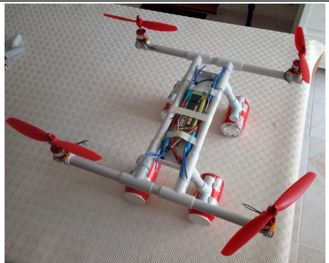
Drone déplié et équipé de flotteurs
