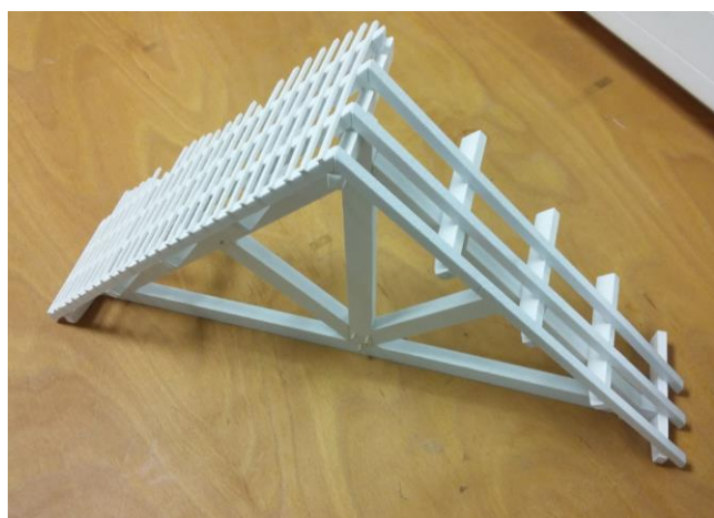
Une ferme de la charpente réalisée en PVC (Etude du vocabulaire technique)
