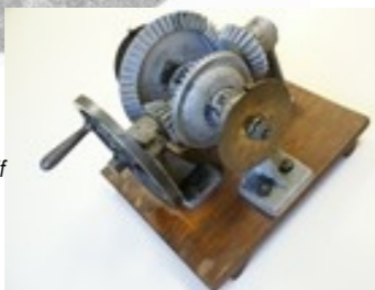
Transmission avec différentiel et dispositif de repérage angulaire (Programme du Groupe Supérieur)
