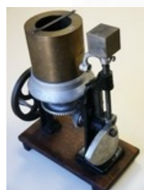
Transformation du mouvement par came et système de tracé de courbes (Programme du Groupe Spécial)
