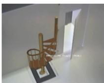
Le principe utilise une « cible » imprimée sur papier qui permet au logiciel de reconnaître le lieu où devra être positionné le modèle numérique. Cette cible est placée dans l'environnement réel et dans le champ de la webcam qui le filme. Une fois la caméra en fonctionnement, face à la cible, le logiciel superpose le modèle numérique à l'image réellement filmée.
