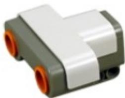
CAPTEUR ULTRASON : mesure de distance par rapport a un objet
