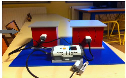
Brancher le capteur de température sur l'entrée INPUT 3
