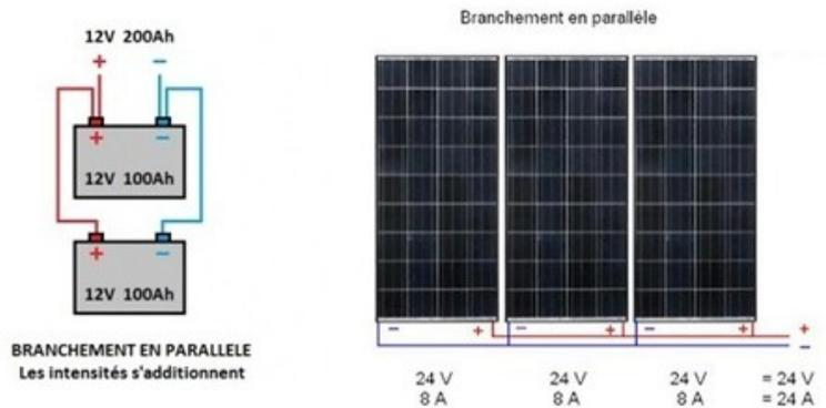
Pour le branchement en parallèle, il n'est pas possible d'avoir des panneaux de tension différente (c'est théoriquement possible avec la tension la plus faible qui prime mais avec un risque de surtension et court-circuit), par contre il est possible d'avoir des panneaux d'intensité différentes, par exemple deux panneaux de 8A et un de 5A donne une intensité de 21A. C'est le branchement idéal lorsqu'on a besoin d'une plus grosse intensité
