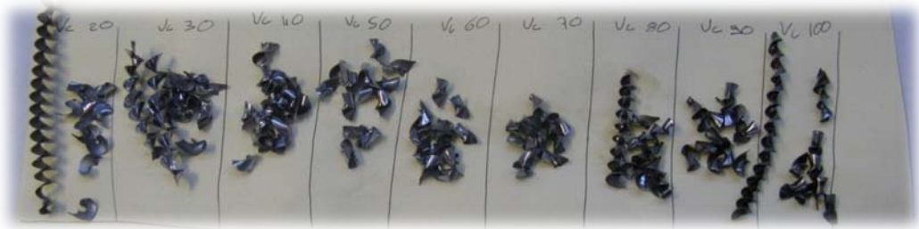
Les paramètres de coupe influent sur la forme du copeau
