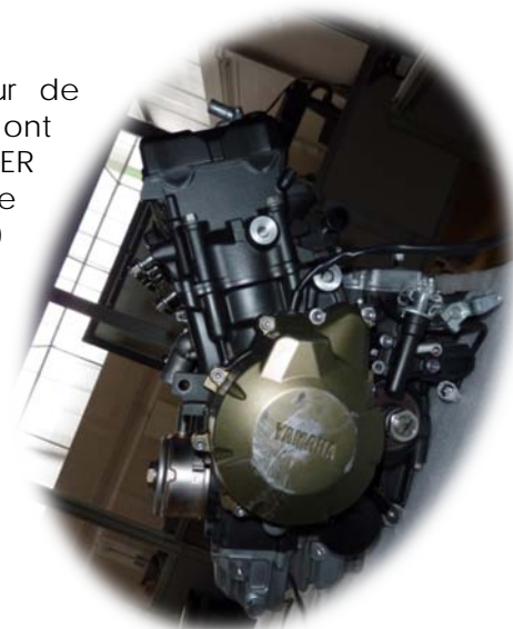
Le moteur réel de moto 650 cm 3
