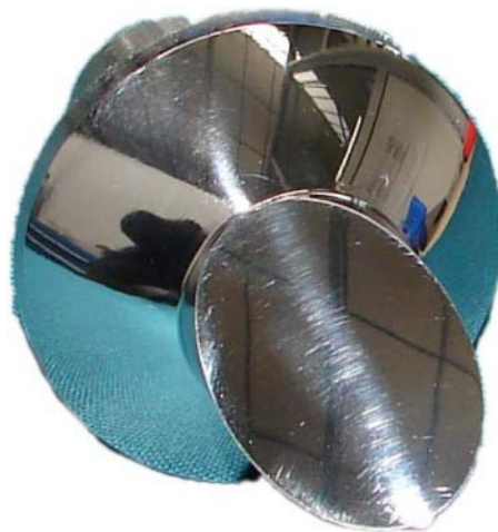
Simulation du capteur catadioptrique complet à deux miroirs
