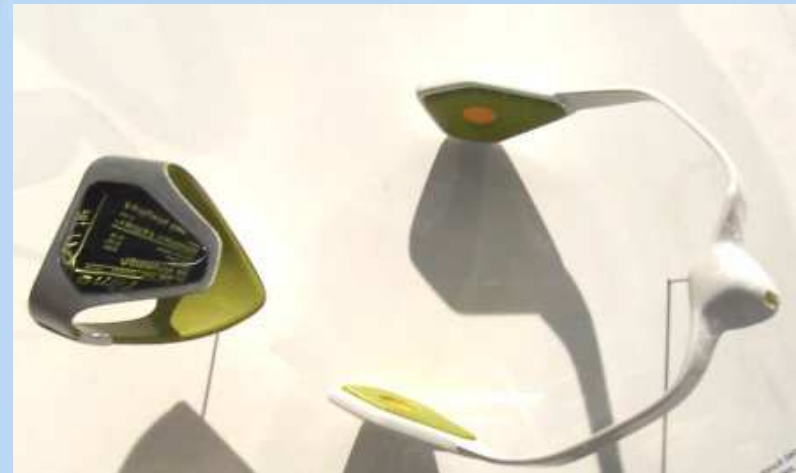
Baladeur mp3 : casque et bracelet (transmission IR)
